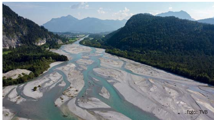
Die Idylle trägt: Die Kies- und Schotterbänke im Lech sind in den letzten Jahren im Bereich Rieden stark angewachsen. Die Hochwassergefahr ist dadurch gestiegen.
